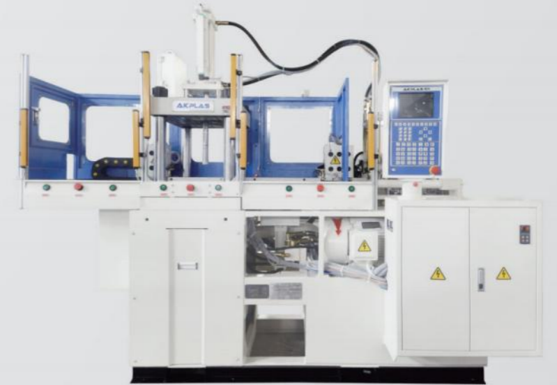
环氧树脂专用机 锁模力 40-250T Clamping Force 射出量 35-1500g Shot Weight
